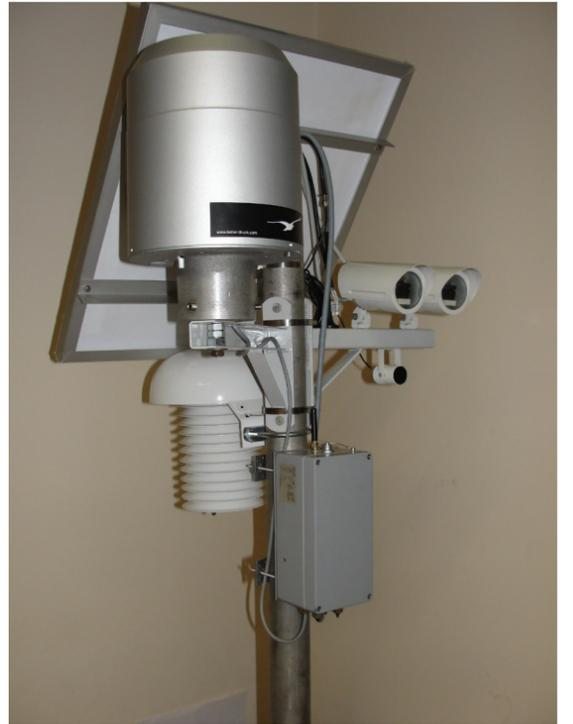
GSM-2 box (below) with rain catcher at a testing site in the Novgorod Oblast: KELLER AG für Druckmesstechnik
